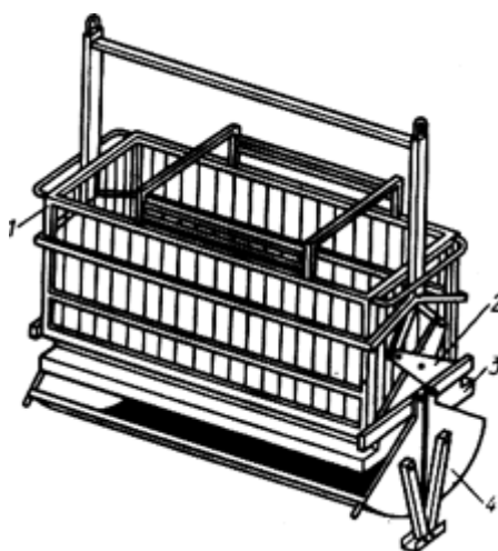
Рис.22. Самозатягивающийся захват 1- рама захвата; 2- натяжные пластины; 3- зажимные балки; 4- захватное устройство
